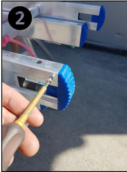
2. Lösen Sie, mit Hilfe eines Schraubendrehers, die (zur Transportsicherung) angebrachten GummifüÙe aus der Aussparung. Beim nächsten Transport, können diese wieder verwendet werden, um ein Verbiegen der Aussparung zu verhindern.
