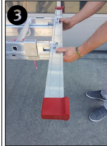
3. Stecken Sie die Hülsen in die passenden Löcher der Quertraverse und schieben Sie diese dann wie abgebildet in die Aussparung der Leiter. (Wenn die Traverse mit 6 Löchern versehen ist, achten Sie darauf die Traverse mittig zu positionieren!)
