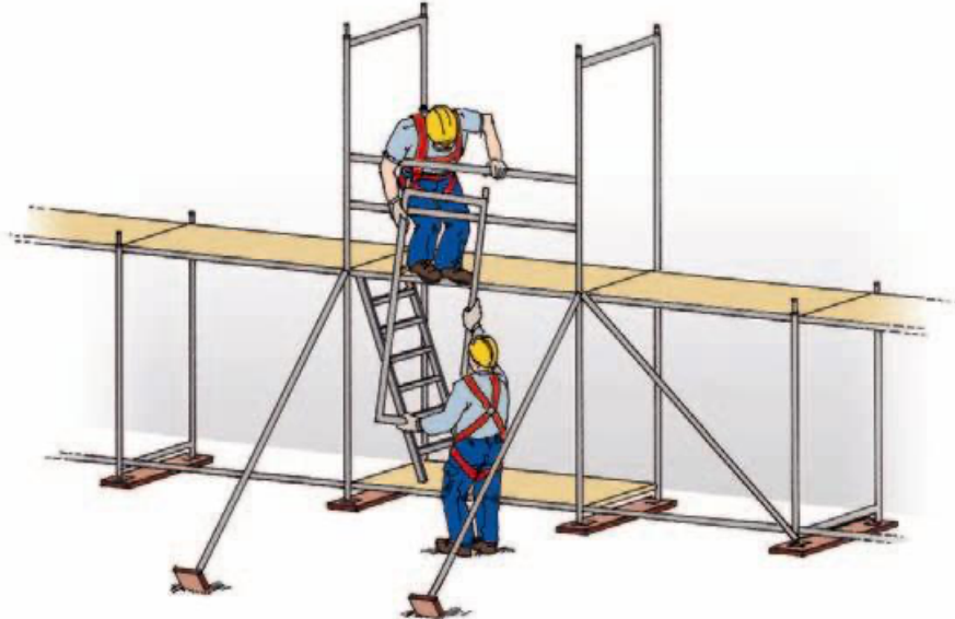
Bild 9: Beispiel für eine vorübergehende Kippsicherung der ersten Gerüstlage (Quelle: H.ZWEI.S Werbeagentur GmbH)
