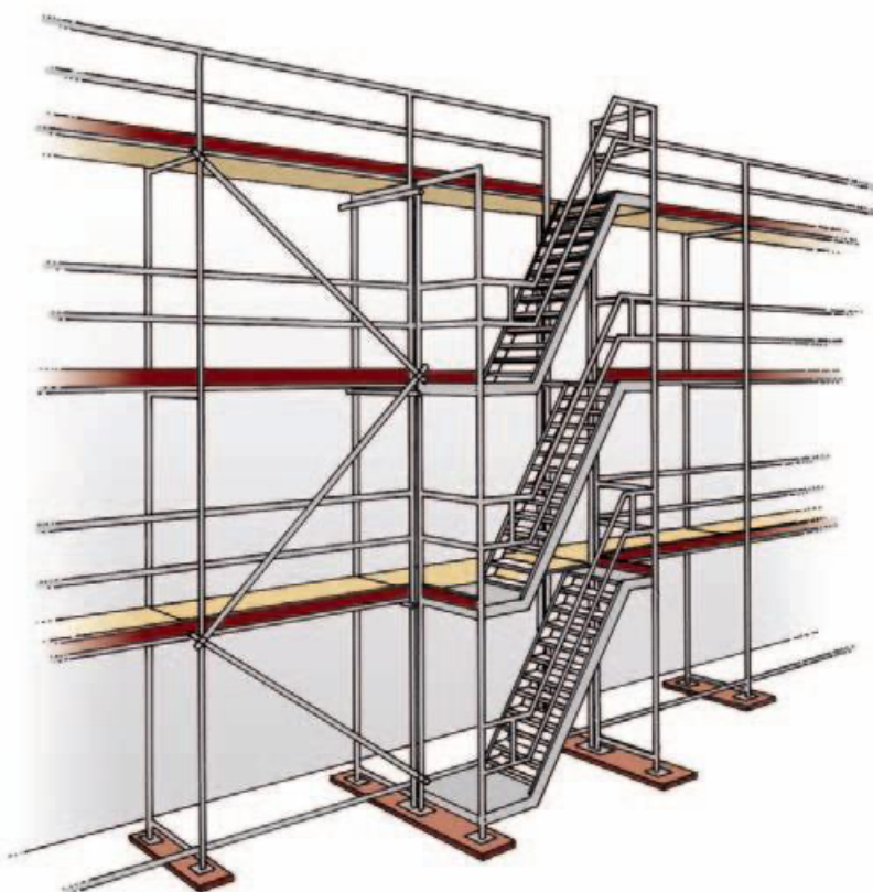
Bild 7: Podesttreppenaufstieg (Quelle: H.ZWEI.S Werbeagentur GmbH)
